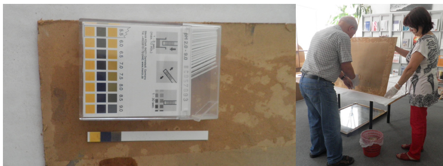
Obrázok 5 Vľavo meranie pH po vyňatí z rámu, vpravo p. Bukovský a p. Boďová pri neutralizácii lepenkovej podložky tabla
